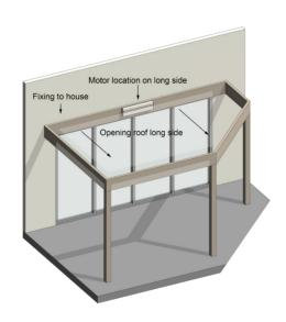
FRAME CAN FOLLOW THE SHAPE OF THE DECK. MOTOR MUST BE LOCATED ON LONG SIDE.
