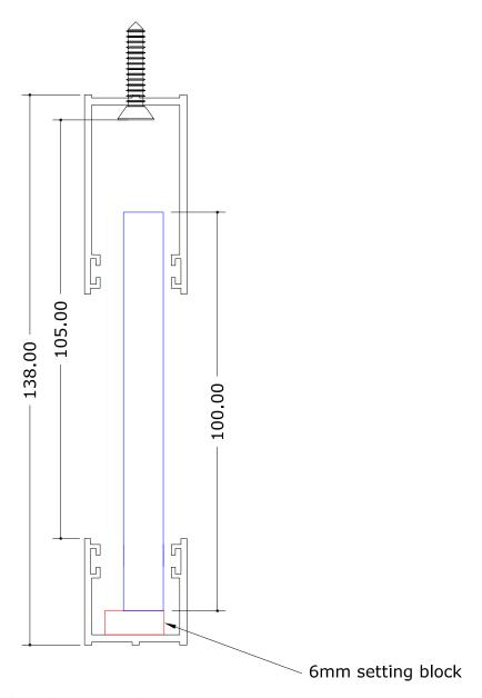
CROSS SECTION HEIGHT - GLASS HEIGHT = OVERALL HEIGHT -38MM
